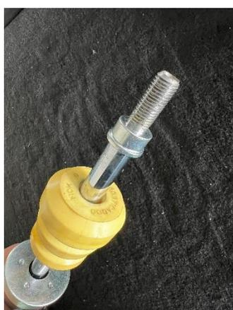
1. 純正バン普拉バーをシャフト挿入方向に引き下げて、純正カラーが見えるようにしてください。
