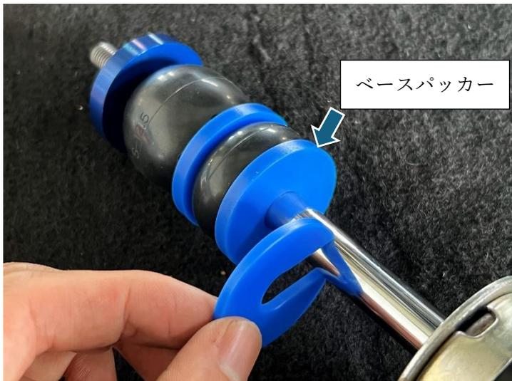
Cパッカーはベースパッカーの下に装着して、切欠き部がMBRに直接当たらないようにしてください。
