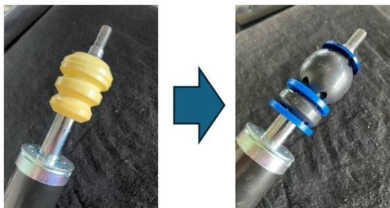
1. フロント純正バンプラバーを取り外し、フロント専用(Φ22mm)の MBR とスペーサーを下記の順番で装着してください。
