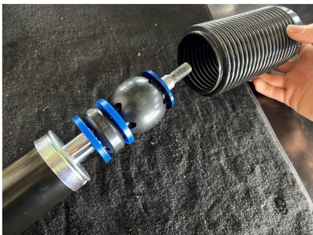
※パッカー調整の作業が行い難くなりますが、MBR 保護のために純正ダストブーツを取り付けることを推奨します。
